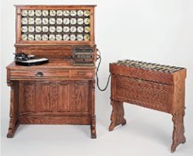
Die erste Hollerith-Maschine 1890. Die Anlage besteht aus einem Pantographlocher, aus dem Zählwerk und der Sortiermaschine.
